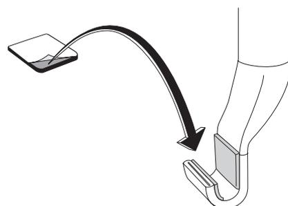
**SV** Kontrollera att krokarna går fritt vid stängning. Om de undre krokarna tar emot stötfångaren kan gummiskyddet delas och monteras på sidorna av de undre krokarna.
